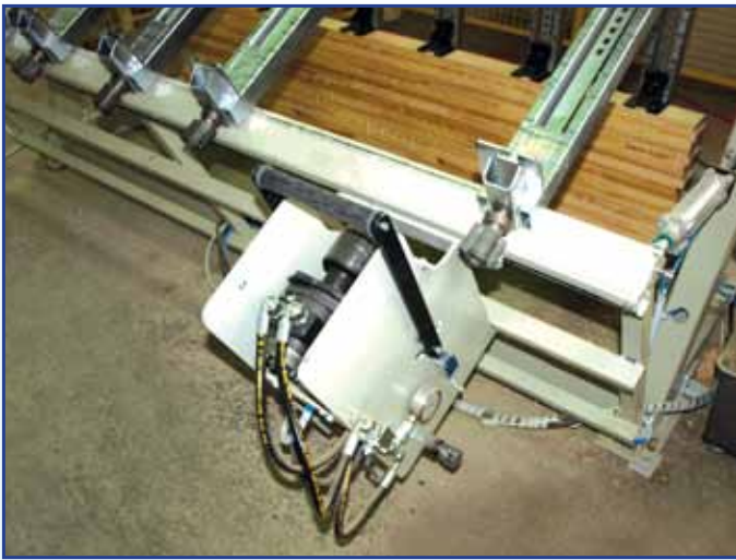
Carriage with hydraulic motor Wagen mit dem Hydraulikmotor Carrello con motore idraulico Engin avec un moteur hydraulique Carro con motor hidraulico
