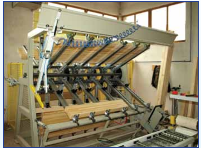
Clamp carrier Verleimstern Strettoio incollaggio listeli Encolleuse en étoile Estrella encoladora de tablas
